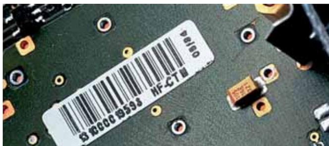
La ilustración muestra una etiqueta resistente a altas temperaturas aplicada sobre la superficie de una placa de circuito impreso para controlar su seguimiento a lo largo de todo el proceso de fabricación, lo que incluye la integración de los componentes de la placa, la soldadura de flujo continuo y el proceso de secado.
