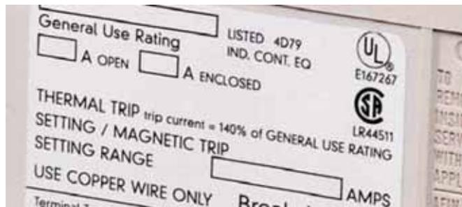
El Material para Etiquetas Reciclable 8000 3M es el primer material para etiquetas compatible con carcasas realizadas en ABS, PC, PC/ABS e HIPS. Utiliza una suave lámina de polímero modificado de color blanco mate, de 80 micras de espesor, y adhesivo acrílico sensible a la presión apto para reciclado según la norma DIN30646.
