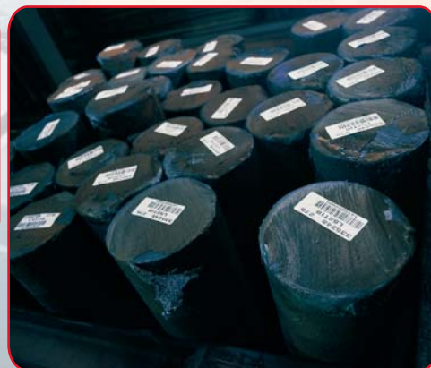
Identificación de tochos de fundición
