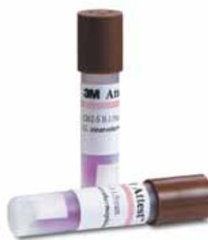
● 3M Attest 1262-S (tapón marrón) esterilización por vapor a  $121^{\circ}\text{C}$  por gravedad y  $134^{\circ}\text{C}$  asistidos por vacío.
